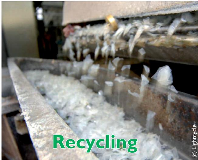
Ziel des Recyclings ist immer die Trennung der ausgedienten Lampen in ihre Einzelbestandteile, so dass diese im Anschluss verwertet werden können. Dadurch wird auch vermieden, dass Quecksilber in die Umwelt gelangt.
