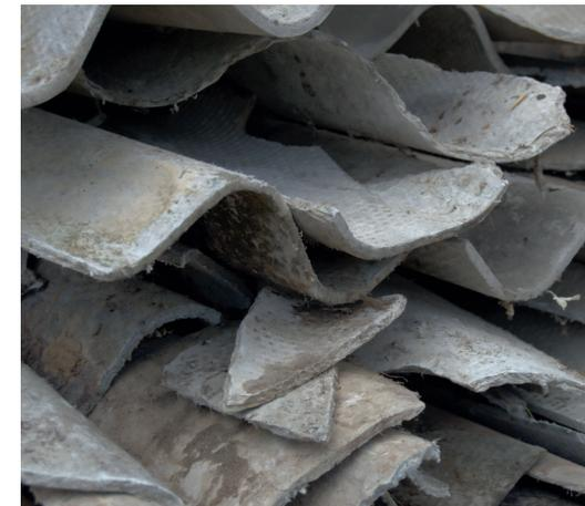
\*Eternit ist der handelsübliche Markenname für Asbestzement (nach dem Namen der Herstellerfirma). Sowohl die asbesthaltigen als auch die ohne Asbest (seit 1993) hergestellten modernen Platten werden unter dem Namen „Eternit“ geführt! Weil sie praktisch aber nicht zu unterscheiden sind, ist für beide Sorten die gleiche Entsorgung notwendig.
